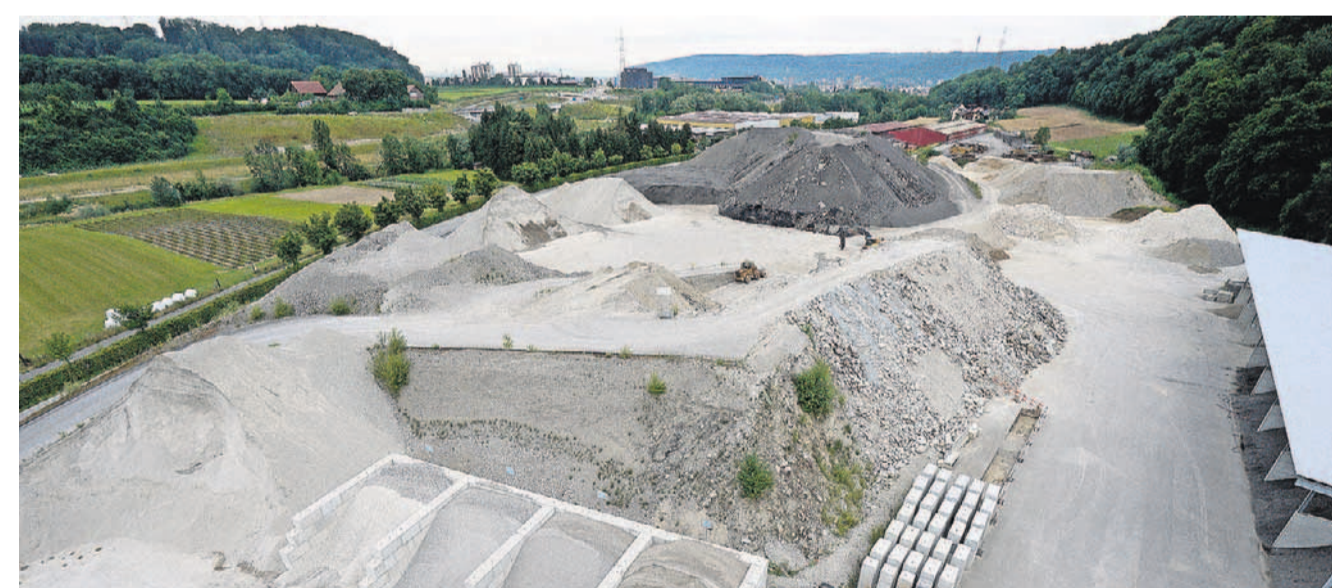
Wo Berge sich erheben: Der graue Haufen im Vordergrund ist Beton, der gemahlen werden soll. Der schwarze Haufen im Hintergrund ist Strassenbelag, den man zwar auch aufbereiten kann, der aber zu wenig Abnehmer findet.
